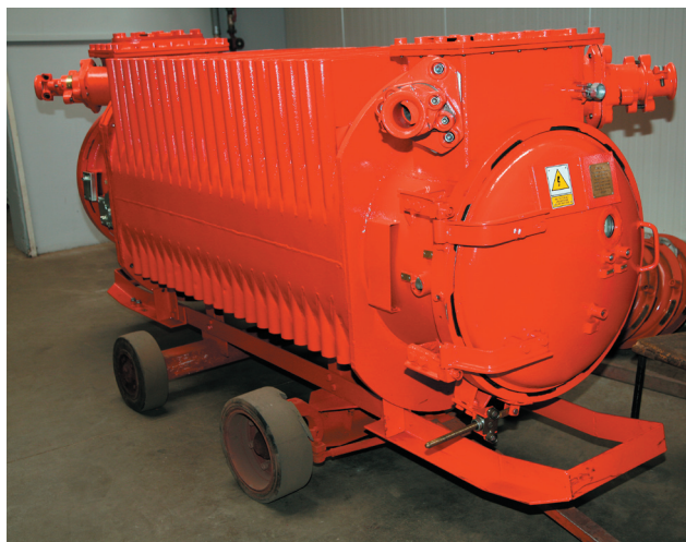
Ryc. 5. Ognioszczelna stacja transformatorowa typu IT3Sb
