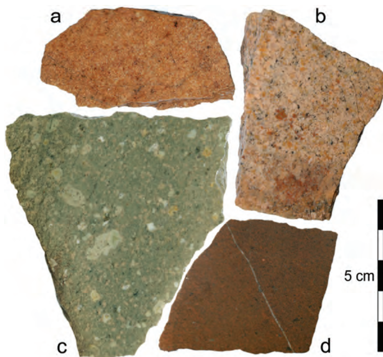
Ryc. 15. Skały żyłowe w sztolni w Bobrowie, aplity: a – drobnokrystaliczny, b – o strukturze granofirowej, c – mikrogranit, d – lamprofir
