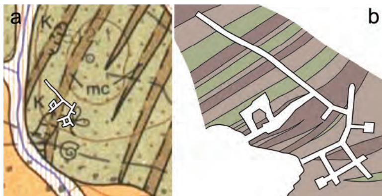
Ryc. 98. Porównanie szczegółowości rozpoznania górotworu w rejonie Kamiennej Góry, na podstawie badań powierzchniowych oraz podziemnych: a – fragment szczegółowej mapy geologicznej w skali 1:25000 (Mastalerz i in. 1994; zaznaczono położenie wyrobisk obiektu w Górze Widok), b – uproszczona mapa geologiczna obiektu podziemnego (por. rozdz. 4.6.1)
