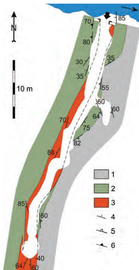
Ryc. 95. Plan geologiczny Hermanloch w Janowcu; 1 – szarogłazy i łupki mułowcowe, 2 – łupki ilaste, 3 – tektonit, 4 – orientacja uskoków, 5 – orientacja powierzchni kontaktu odmian skalnych, 6 – orientacja warstwowania w łupkach (według Zagożdżona i in., 2014)
