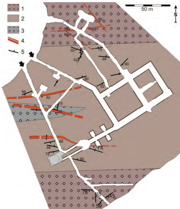
Ryc. 86. Uproszczona mapa geologiczna podziemi zamku Książ (poziom główny); 1 – zlepienie polimiktyczne, 2 – piaskowce, częściowo z otoczkami, 3 – zlepienie mułowcowe, 4 – szerokie strefy uskoku, 5 – uskoki (podkład – według planu Kaszy i in., 2018, zmodyfikowany)
