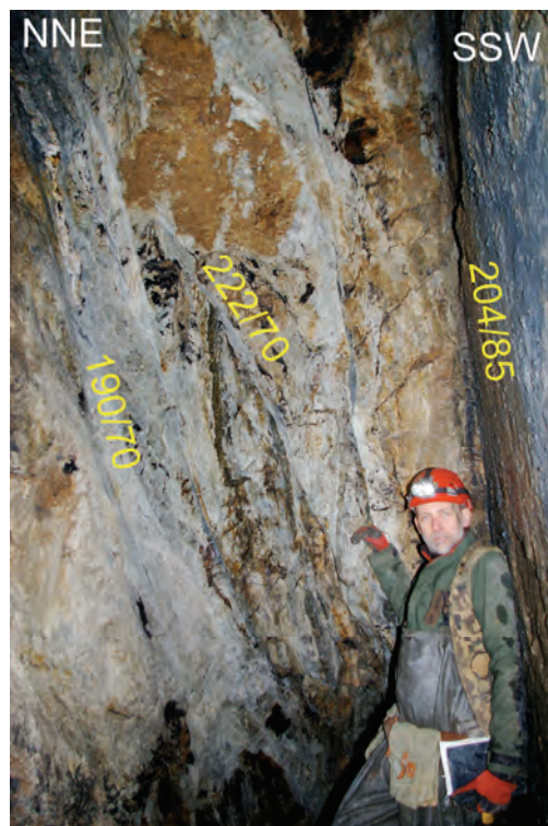
Ryc. 43. Przekrój poprzeczny największego uskoku w komorze eksploatacyjnej, centralnej części kopalni Amalie , widoczne powierzchnie poślizgów tektonicznych oraz zwietrzałe bloki skalne w obrębie uskoku (fot. K. Zagożdżon)
