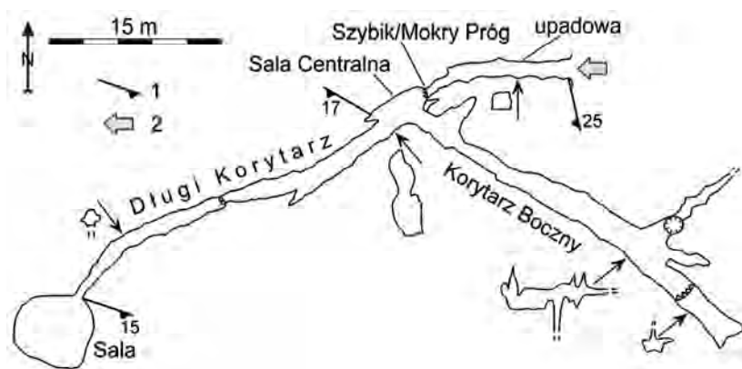
Ryc. 56. Plan Złotej Sztolni ze wskazaniem jej najważniejszych części i poprzeczne profile wyrobisk, wskazano orientację foliacji (według Zagożdżona i Zagożdżon 1998b; Lorenca i Zagożdżona 2002a, 2002b – poprawione i uzupełnione; stan dostępności na 1998 r. – przed powodzią); 1 – orientacja foliacji, 2 – wlot
