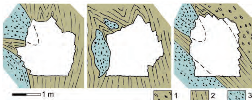
Ryc. 92. Geologiczne profile sztolni transportowej (w płaszczyznach równoległych, wykonane od zachodu co około 3 m, północ po prawej) ilustrujące charakter i intensywność deformacji ośrodka skalnego; 1 – zlepienieć polimiktyczny, 2 – mułowiec, 3 – zlepienieć onkoidowy
