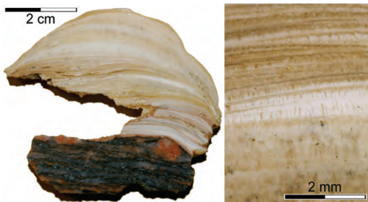
Ryc. 102. Przekrój stalagmitu kaltemitowego na fragmencie gnejsu biotytowego (Młoty): a) makrofotografia, b) powiększenie elementów struktury – obraz z mikroskopu stereoskopowego
